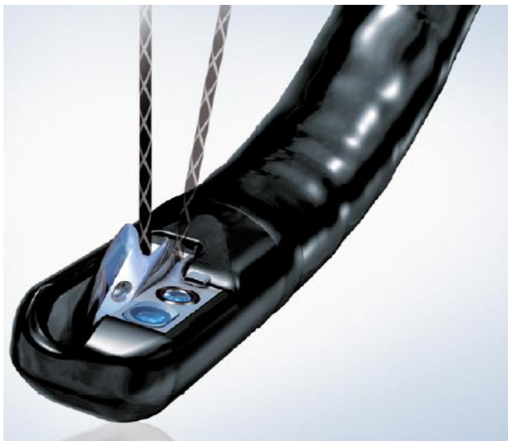
10.27. att. Duodenoskops ar vadītāja fiksēšanas funkciju, kas nodrošina vieglāku un precīzāku nepieciešamo instrumentu nomaiņu
