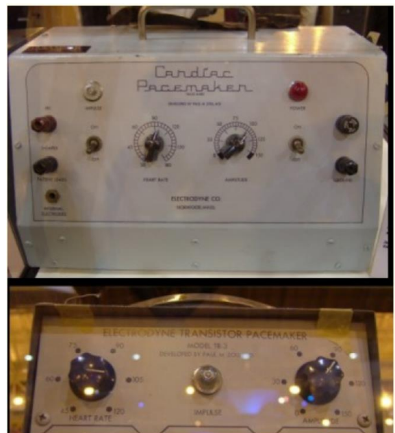
2.1. attēls A – stimulators fizioloģijas pētījumiem B - sirds stimulators ar adatveida elektrodiem
