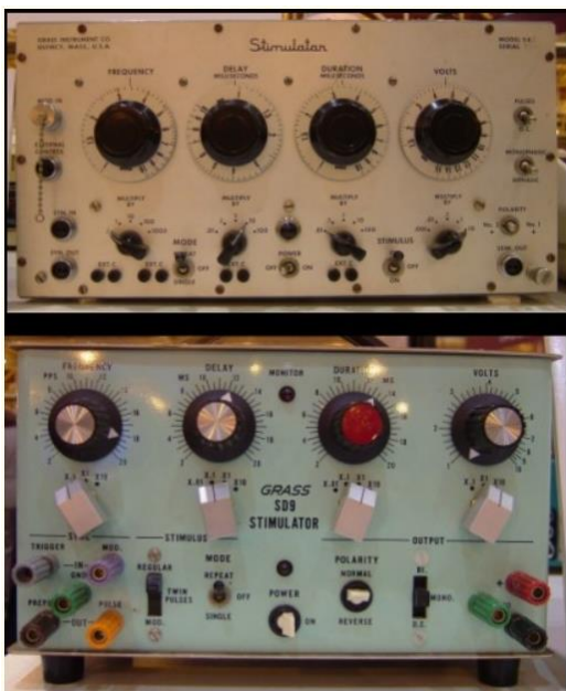
2.1. attēls A – stimulators fizioloģijas pētījumiem B - sirds stimulators ar adatveida elektrodiem
